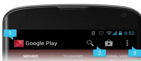
Figura 6.34 - Uma actionBar incluindo [1] o ícone da aplicação, [2] dois ícones de ação e um ícone overflow.
